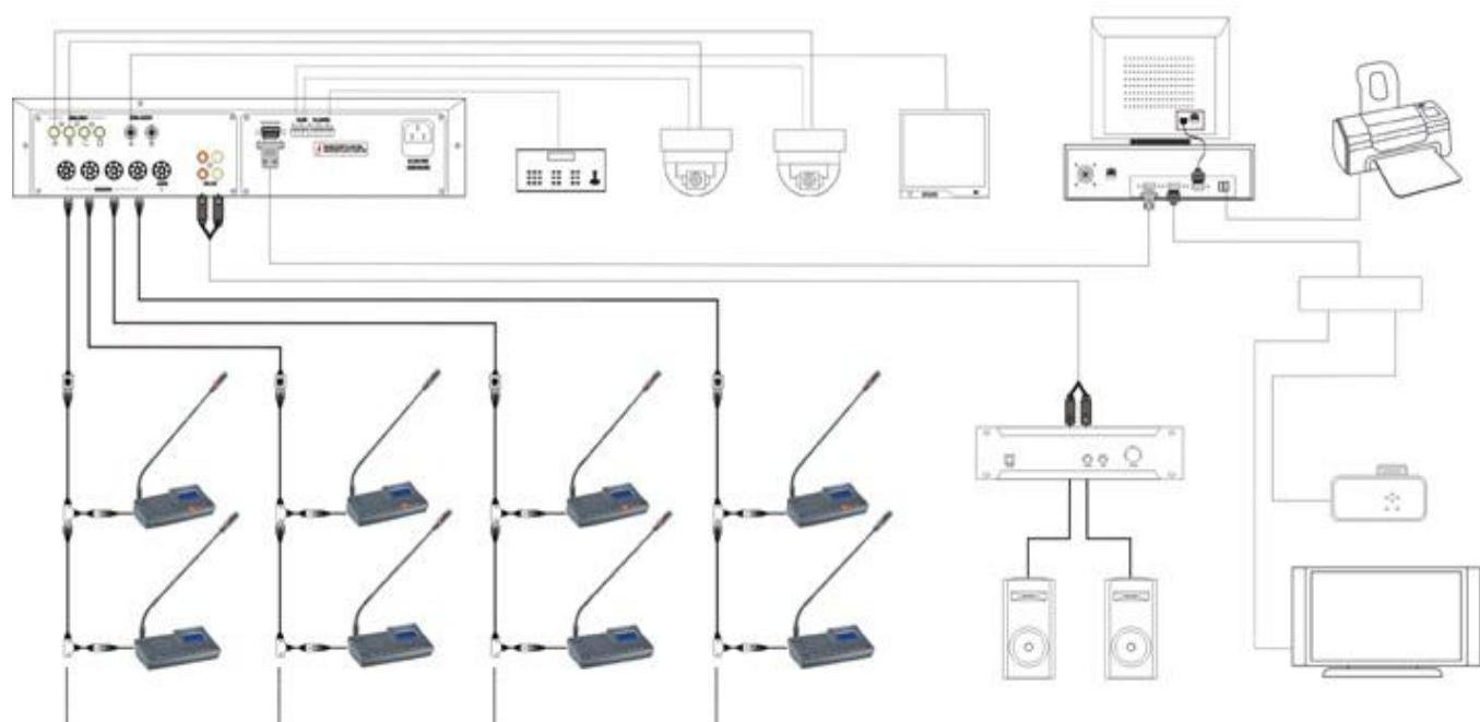
**Схема подключения центрального модуля и модуля расширения**
