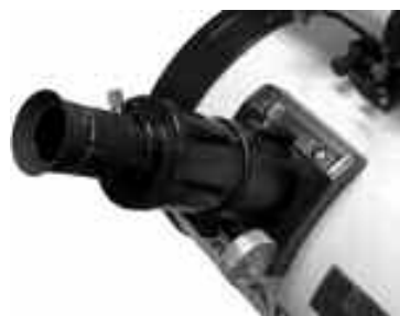
Трубка расширения фокусировщика с держателем окуляра и окуляром.
