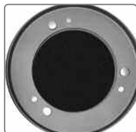
6 винтов на задней стороне корпуса первичного зеркала.
