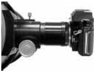
Т-адаптер соединен с фокусировщиком и камерой,
