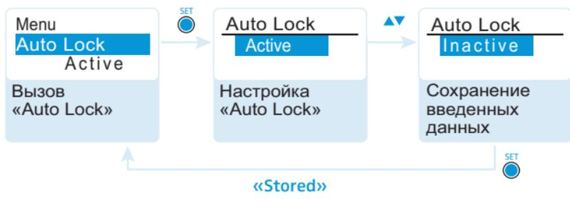
Эта блокировка предотвращает случайное выключение передатчика или выполнение изменений. В текущей стандартной индикации символ замка ⑤ указывает на то, что блокировка кнопок включена.
