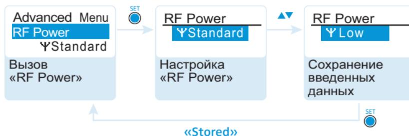
В пункте меню «RF-Power» Вы можете выбрать один из 2 уровней мощности передачи. Строго соблюдайте информацию, приведенную на вкладыше с перечнем частот!
