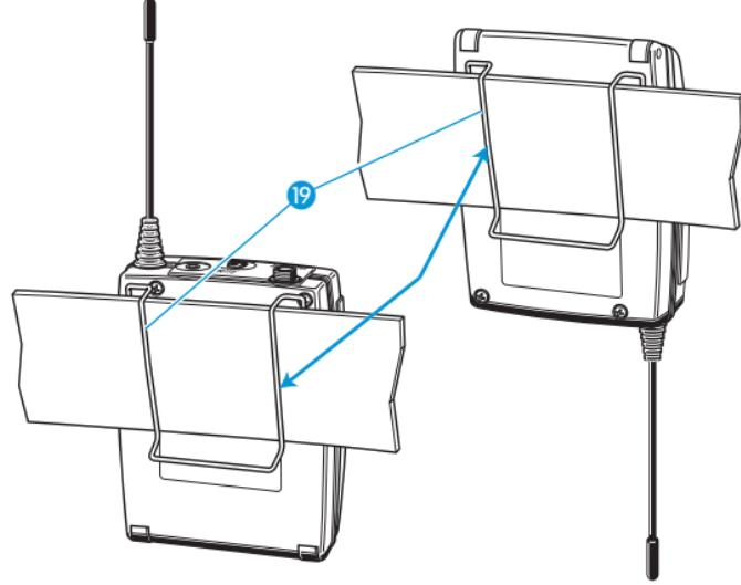
Передатчик можно также закреплять на одежде антенной вниз. Для этого нужно вынуть зажим 19 и установить его вновь, повернув на 180°.
