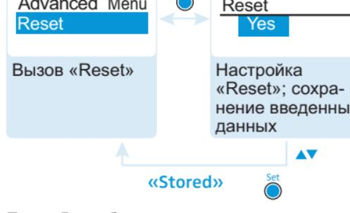
Если Вы сбрасываете настройки передатчика, то сохраняются только настройки пилот-сигнала и канальных банков «U1» - «U6».
