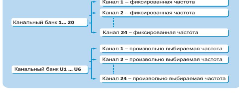
В канальных банках «1» – «20» на каждом из каналов предварительно настроена фиксированная частота.
